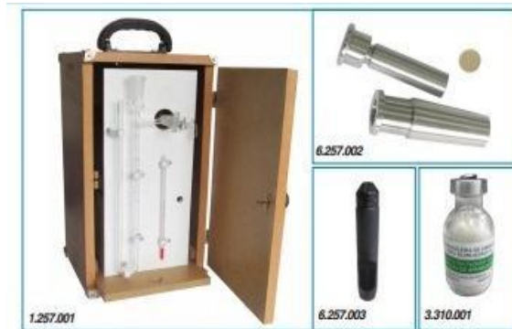
Figura1 – Permeabilímetro de Blaine
